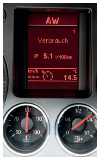
Verbrauch und optimaler Schaltzeitpunkt werden im Display dargestellt
